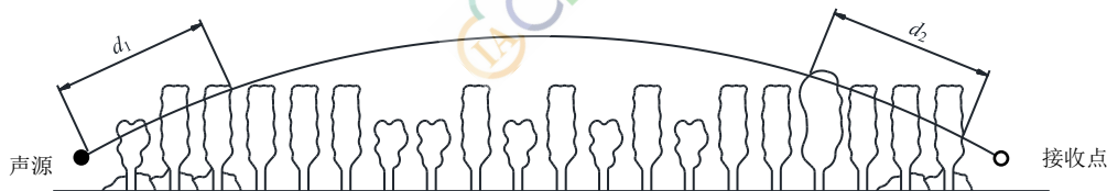
图 A.9 通过树和灌木时噪声衰减示意图
